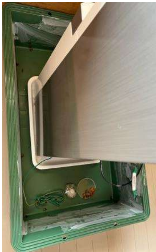
図2. 試験状況 (外容器にトレイ-Aを置き、 その上に筐体を設置し観察)
